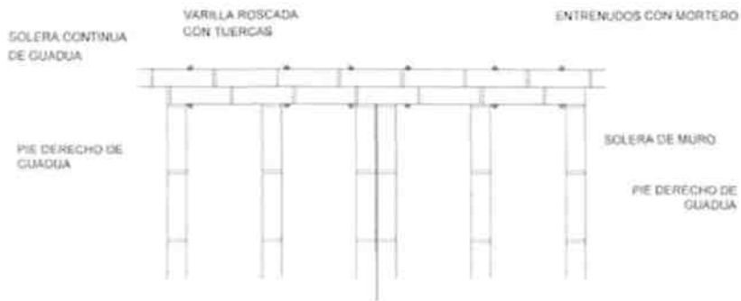
Ilustración 42. Solera continua de Guadua.
