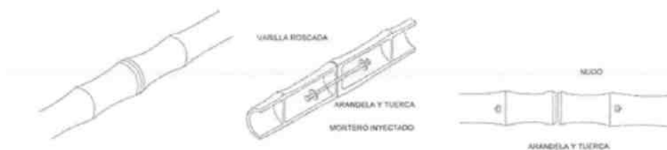
Ilustración 33. Empalme a tope de Guaduas. (INBAR, 2011)
