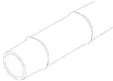
Ilustración 27. Corte recto. (Asociación Colombiana de Ingeniería Sísmica AIS, 2010)
