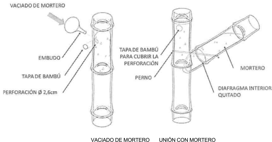
Figura 13: Vaciado de mortero y unión de los culmos con mortero
