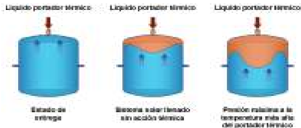
Figura 7. Esquema de funcionamiento de un vaso de expansión cerrado.
