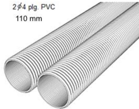
**FIGURA 11. Canalización secundaria (CS) - Perspectiva**
