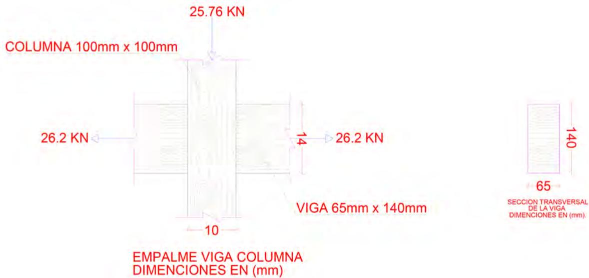
Figura 33: Sección de empalme entre columna y viga.
