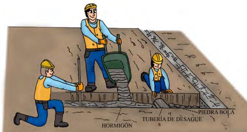
Figura 44: **Fundición del cimiento de la cadena.**
