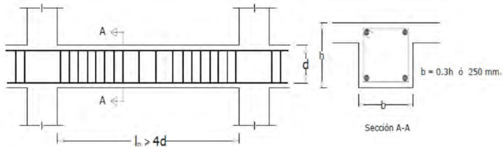
Figura 87: **Características de la sección de las vigas**
