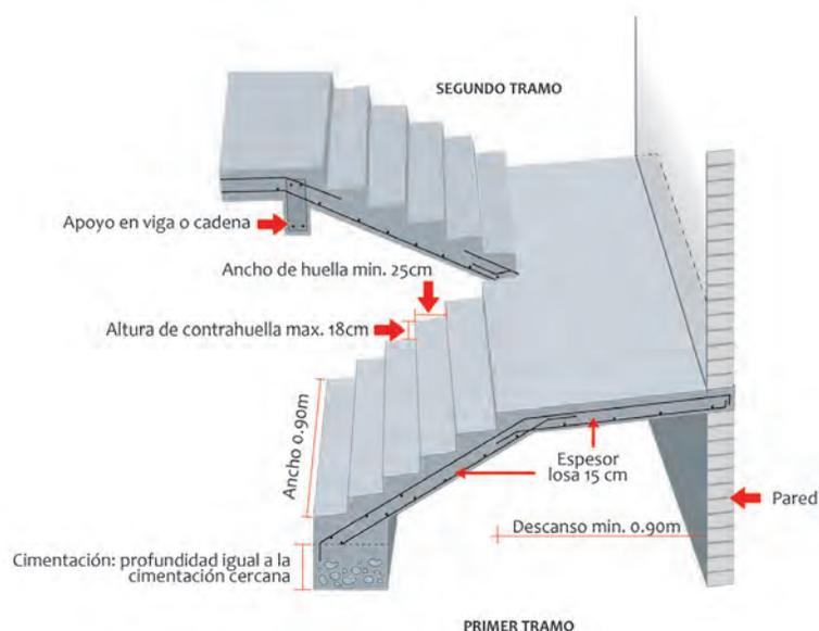
Figura 99: **Elementos y dimensiones de una escalera.**
