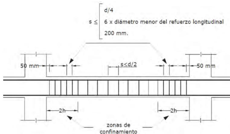
Figura 89: **Separación de estribos**
