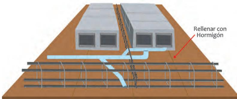
Figura 93: Instalaciones eléctricas y sanitarias en la losa
