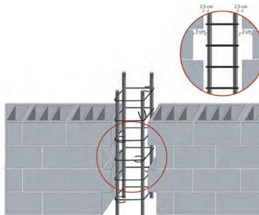
Figura 68: **Acabado “endentado” de muro contra columna**
