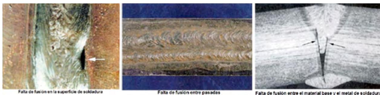
Figura 130: Defectos en la soldadura: fusión incompleta
