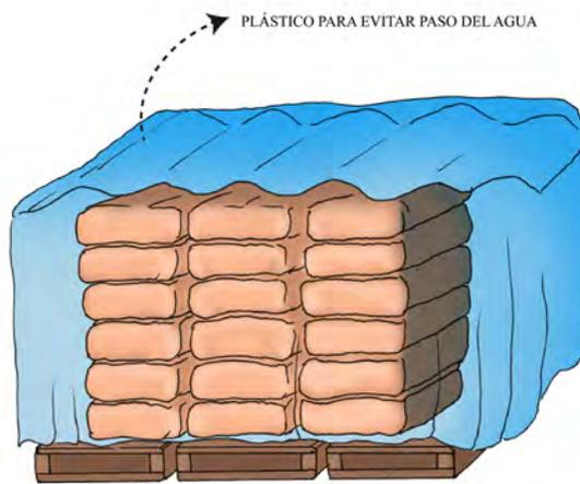
Figura 16: **Almacenamiento del cemento protegido de la humedad**
