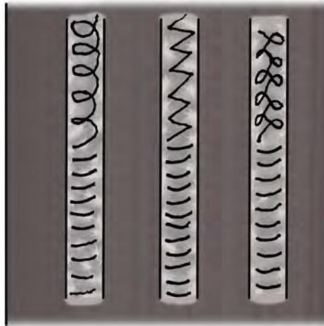
Figura 116: **Soldadura ondeada**
