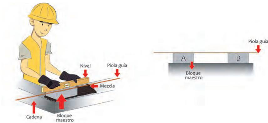
Figura 63: **Colocación de bloques maestros y piola guía**
