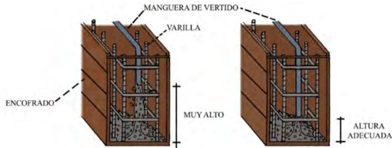
Figura 19: **Hormigón colocado cerca de su posición final**
