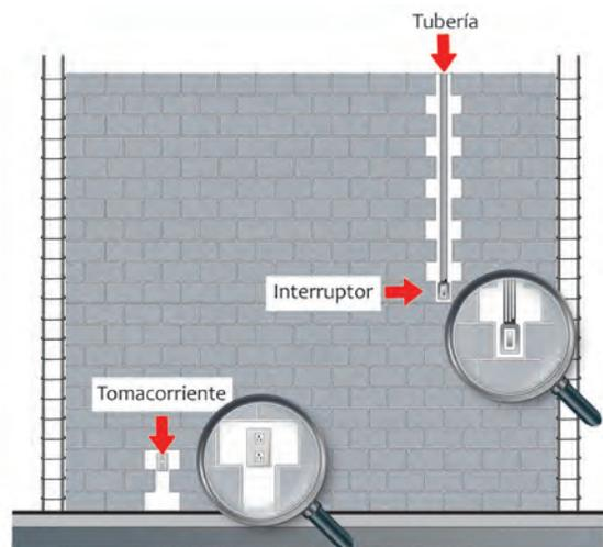
Figura 71: **Conexiones eléctricas en el muro en columnetas**
