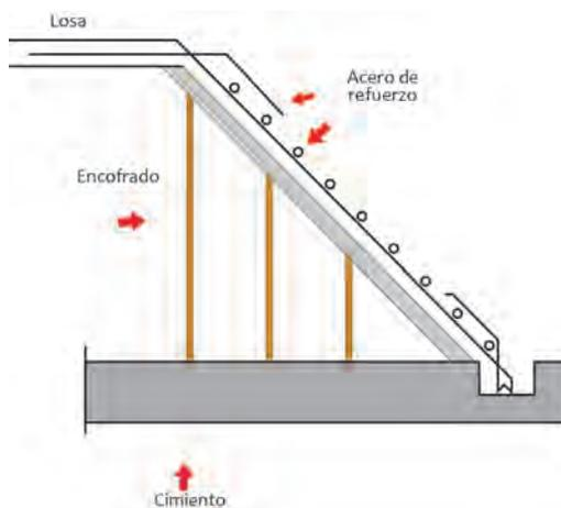
Figura 102: **Armado de una escalera.**
