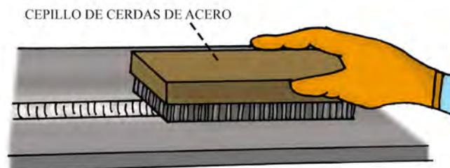
Figura 144: **Limpieza final de cordón de soldadura.**
