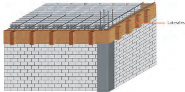
Figura 86: **Encofrado de losa: tablas laterales**
