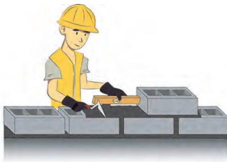
Figura 64: **Distribución horizontal del mortero**
