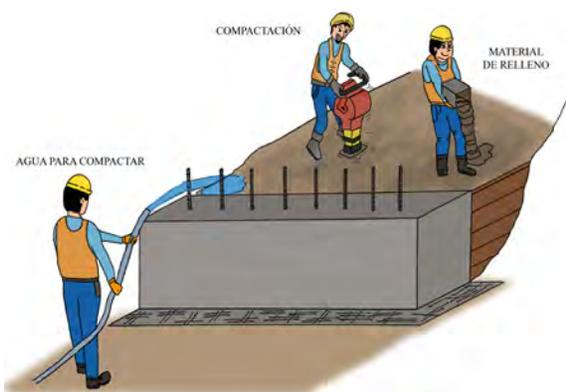
Figura 35: **Construcción de relleno que soporta muro de contención**
