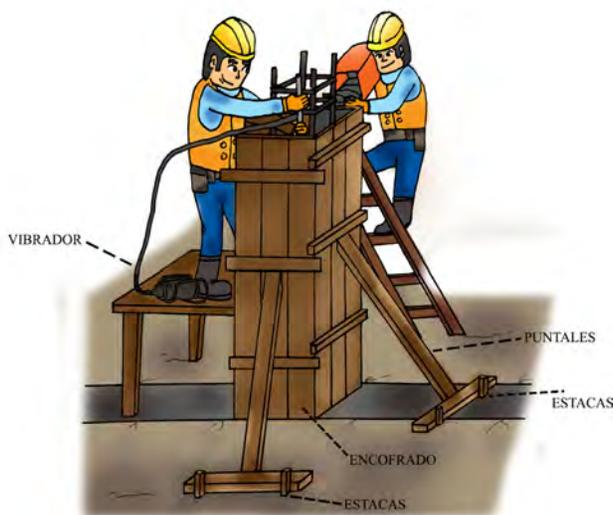
Figura 78: **Fundición de columnas**
