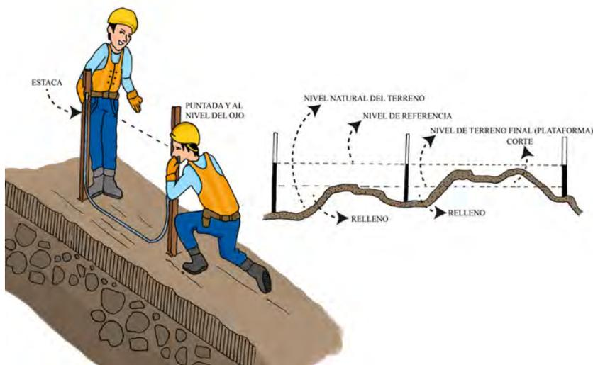
Figura 24: **Nivelación del terreno: método de la manguera**
