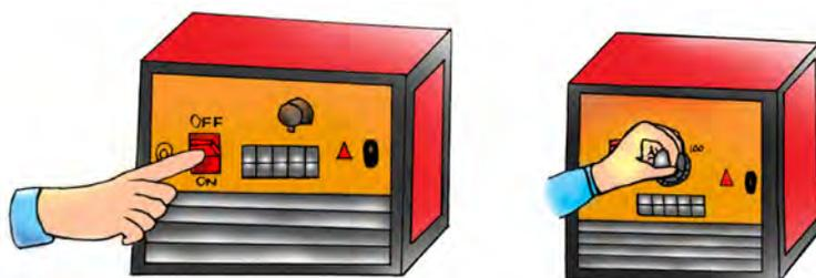
Figura 138: **Encendido y regulado de intensidad de soldadora**
