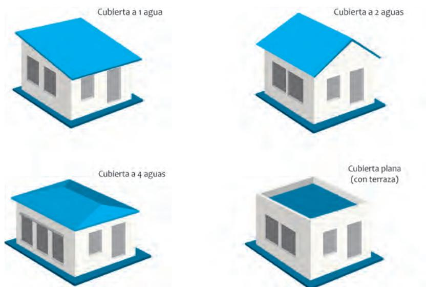
Figura 98: Tipos de cubiertas.
