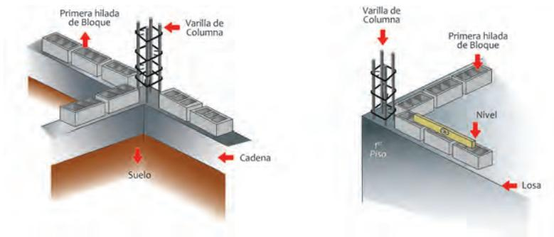
Figura 62: **Colocación de primera fila de bloques sobre cadena o sobre losa**
