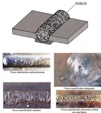
Figura 128: Defectos en la soldadura: soldadura porosa
