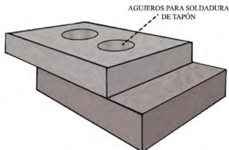
Figura 118: **Soldadura de tapón**
