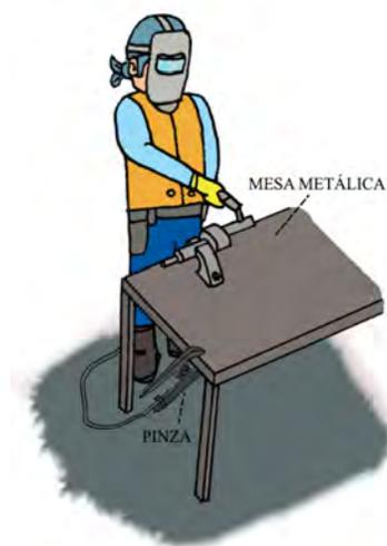
Figura 134: **Colocado y aseguramiento de las pinzas de tierra**
