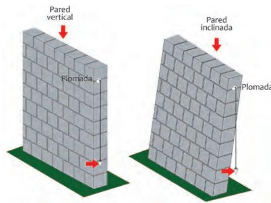
Figura 70: **Control de verticalidad de muro**
