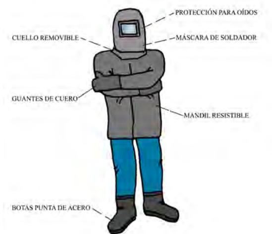
Figura 135: **Equipo de protección para soldar**
