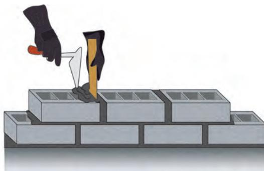
Figura 66: **Colocación del mortero en juntas verticales**
