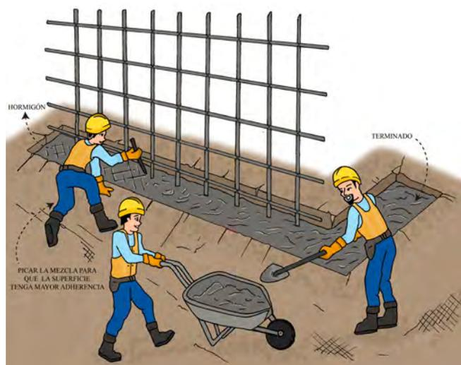
Figura 32: **Fundición del pie de muro de contención**
