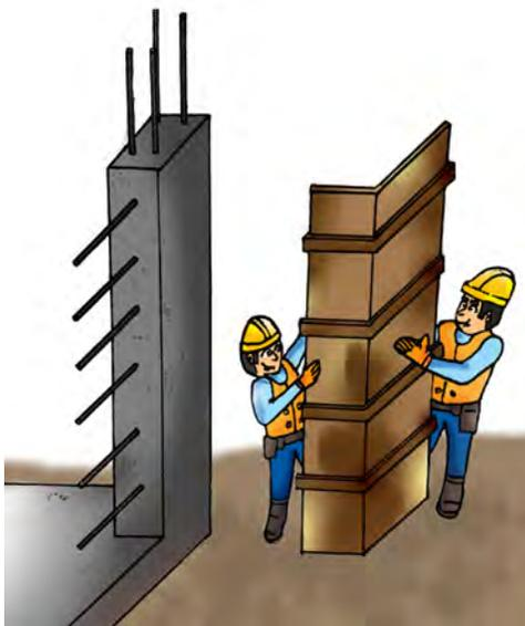
Figura 58: **Muro estructural de mampostería confinada, tipo 2 (se construyen las columnas, se dejan chicotes o varillas horizontales y luego se construyen los muros anclados a las columnas mediante los chicotes).**
