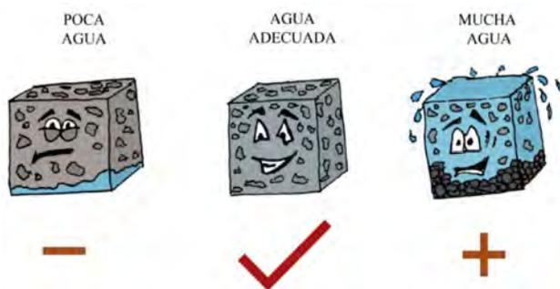
Figura 17: La cantidad de agua justa produce el mejor hormigón
