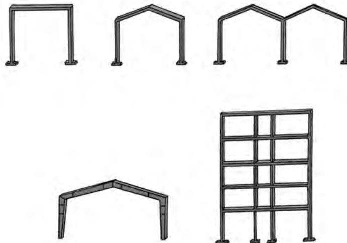
Figura 106: **Tipos de pórticos usados en la construcción**
