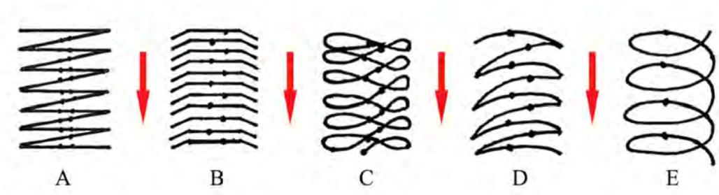
Figura 117: **Movimientos para efectuar una soldadura ondeada**
