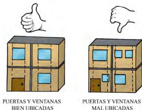
Figura 8: **Alineación de aberturas para puertas y ventanas**
