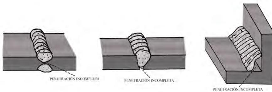
Figura 131: Defectos en la soldadura: penetración incompleta
