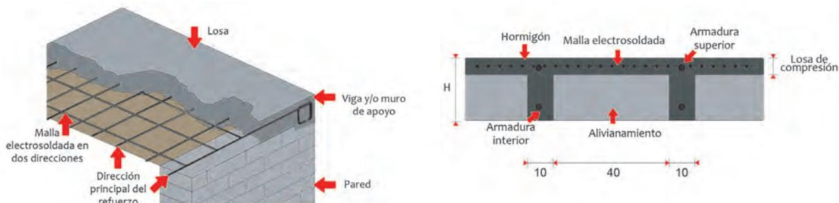
Figura 81: Losa maciza y aligerada
