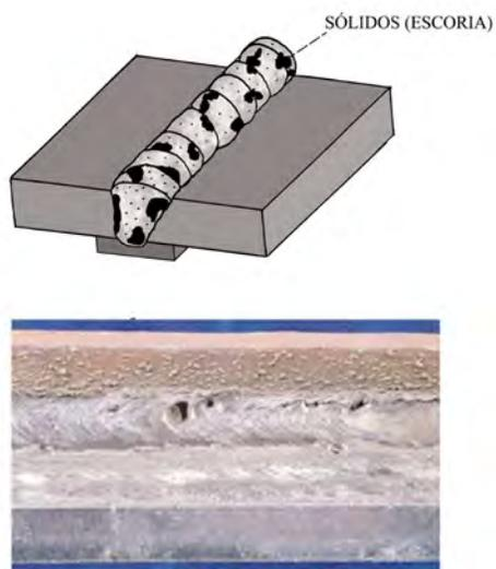
Figura 127: Defectos en la soldadura: Inclusiones sólidas
