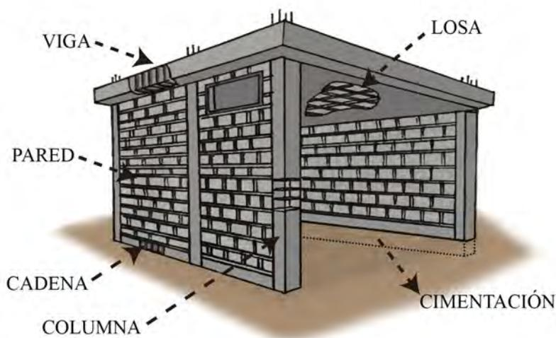
Figura 5: Elementos estructurales que conforman una vivienda
