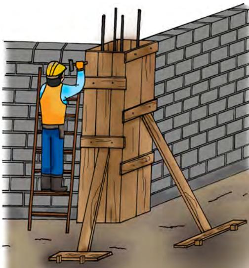
Figura 77: Encofrado de columnas
