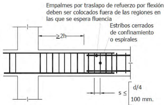
Figura 88: **Traslape de varillas de refuerzo longitudinal**
