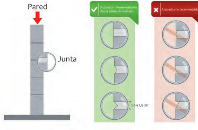
Figura 67: **Acabado y espesor de las juntas**
