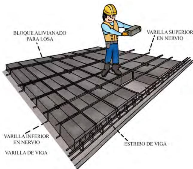
Figura 92: Colocación de bloques alivianados en la losa
