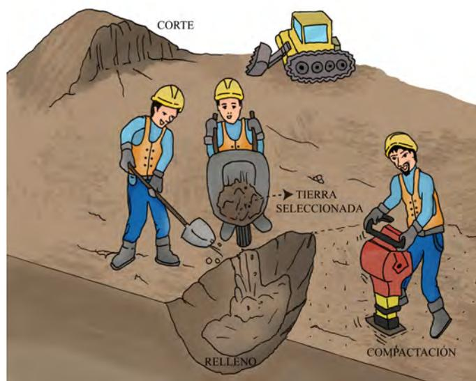
Figura 25: Nivelación del terreno: corte y relleno
