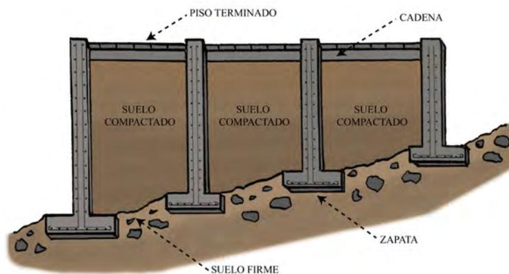
Figura 36: **Cimentación sobre suelo firme cuando existe relleno**
