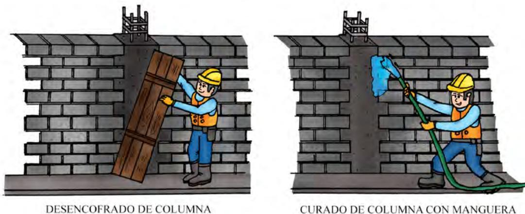
Figura 79: **Desencofrado y curado de columnas**
