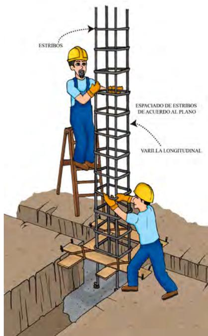
Figura 74: Armado de varillas de acero de columnas
