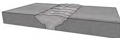
Figura 119: **Soldadura de ranura**
